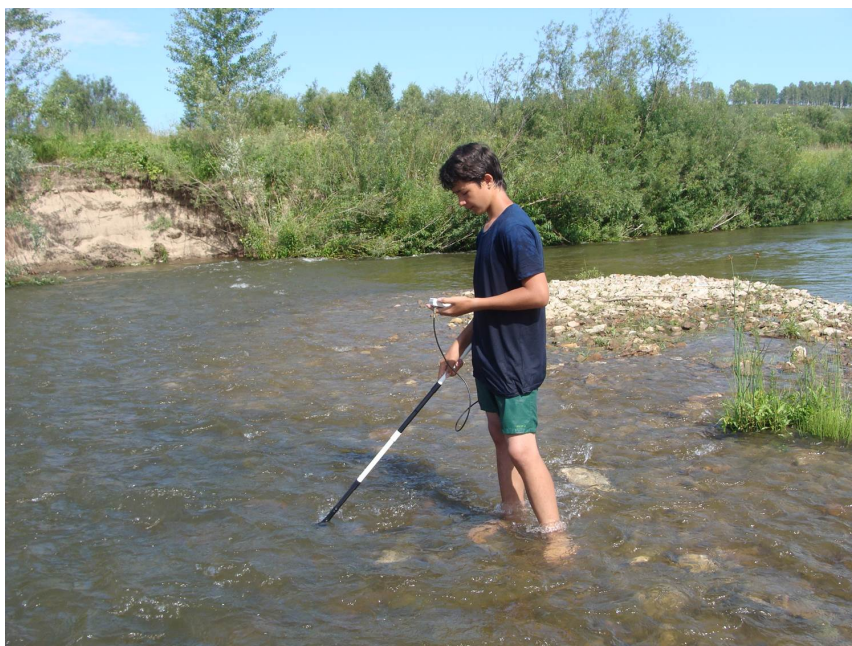
Рисунок 2. Эксперимент по измерению скорости течения воды в реке
