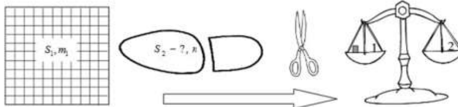
Рис. 2. Последовательность и содержание практической работы «Определение давления твердого тела»
